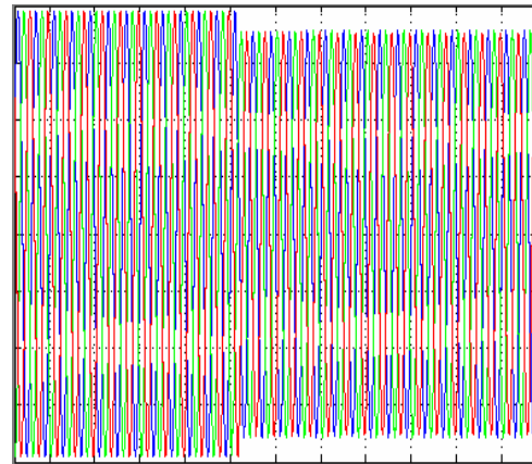
Fig.5. Voltage sag due to fault
