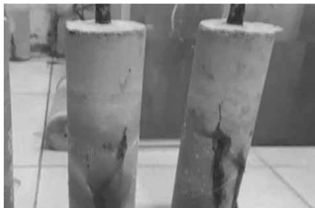
Hình 8. Mẫu BTCS sau khi thí nghiệm ăn mòn gia tốc
